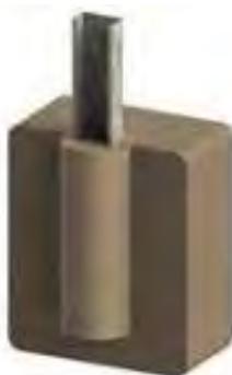
Imagen-croquis de cimentación con preperforación
