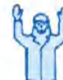
PELIGRO, ALTO O PARADA DE EMERGENCIA.
